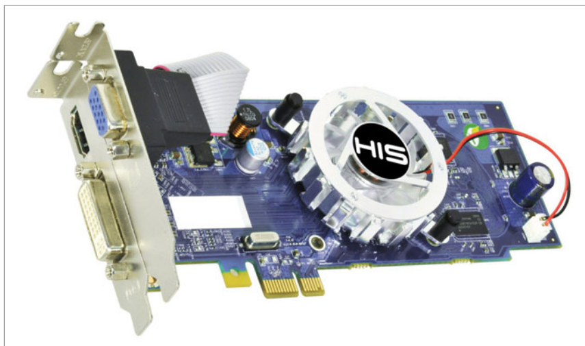
Rysunek 2.11. Przykład karty ze złączem PCI-Express x1
