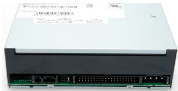
Rysunek 6.3. IDE to ustępujący złączu SATA interfejs napędów optycznych
