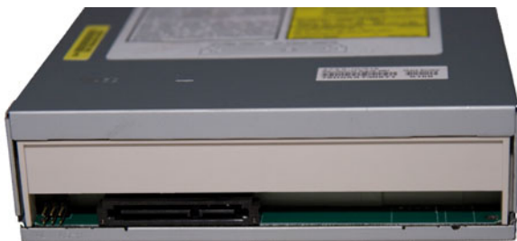
Rysunek 6.2. SATA jest najpopularniejszym interfejsem do komunikacji napędów optycznych i komputera
