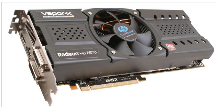
Rysunek 2.12. Karta graficzna ze złączem PCI-Express x16
