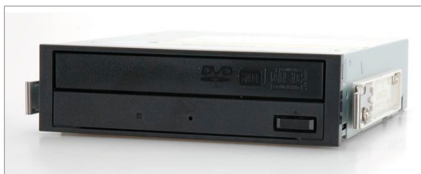
Rysunek 6.1. Przykładowy napęd optyczny — nagrywarka płyt DVD
