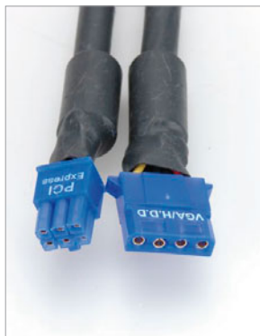
Rysunek 3.24. Nowoczesne karty graficzne bardzo często potrzebują dodatkowego zasilania
