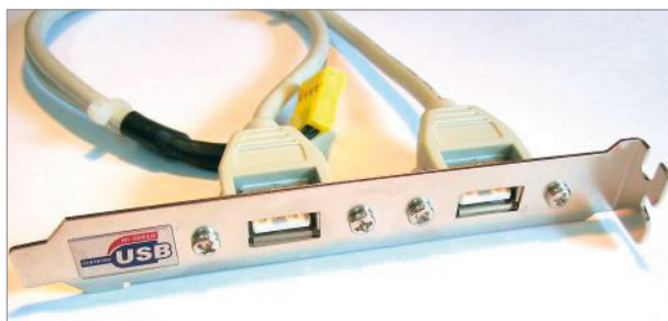
Rysunek 9.3. Przykładowy śledź znajdujący się w komplecie z płytą główną
