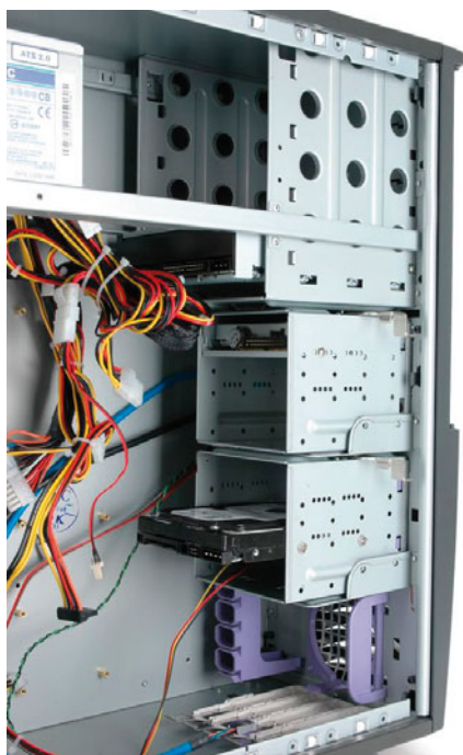
Rysunek 5.7. Montaż dysku w obudowie — etap czwarty
